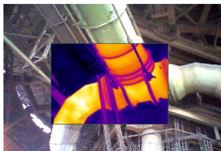
熱風メインパイプのパイプが湾曲した箇所で耐火レンガが破損している状況
