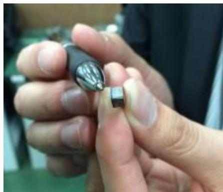
超合金カッターの底部接触面で、そのサイズは2mm×1.5mmである
